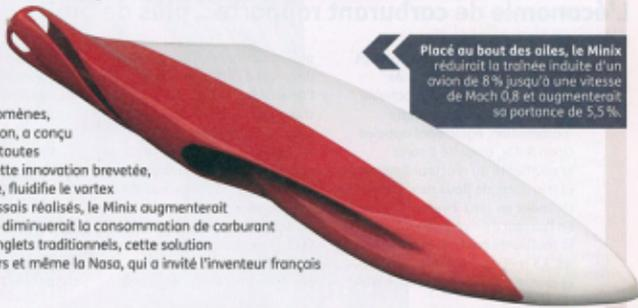
Placé au bout des ailes, le Minix réduirait la traînée induite d'un avion de 8% jusqu'à une vitesse de Mach 0,8 et augmenterait sa portance de 5,5%.
